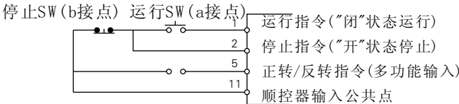
3线制程序的接线举例
